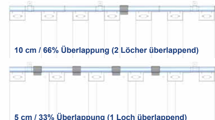
10 cm / 66% Überlappung (2 Löcher überlappend)
