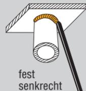
Rohr: Achse: ASME: 4F
